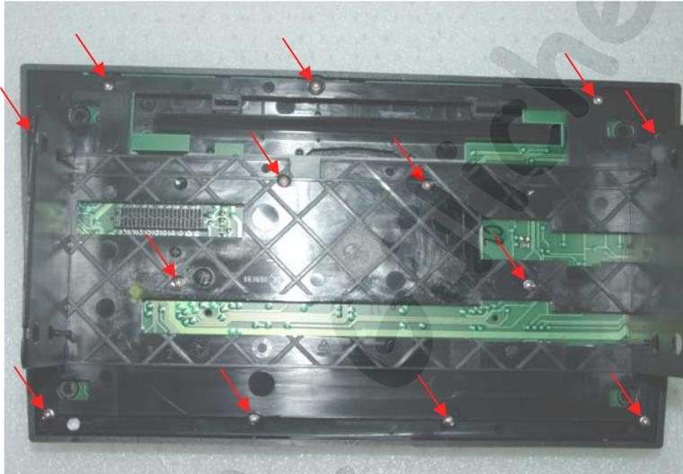
Hinten in der Bedieneinheit die 13 Torxschrauben T6 entfernen.
