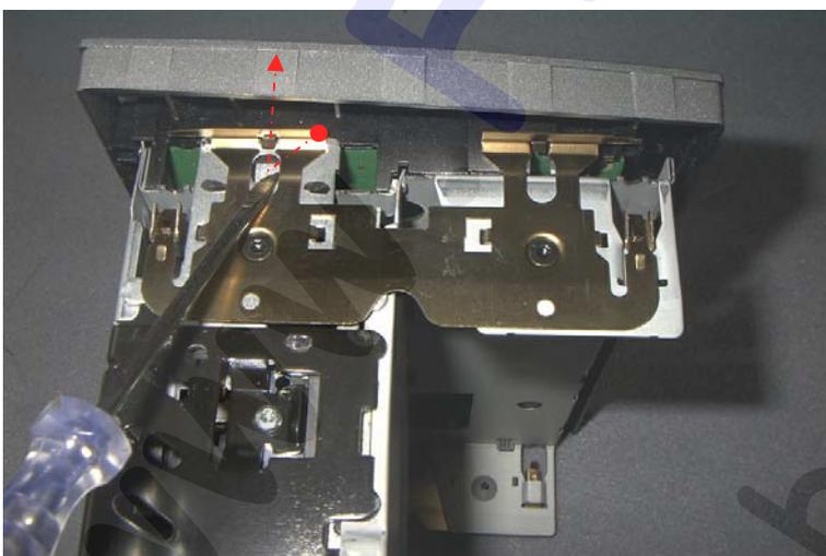
Anschließend links und rechts an der Seite des Gerätes die Rastnasen mit einem dünnen Schraubendreher ebenfalls entriegeln und die Blende vorsichtig nach vorne ziehen.
