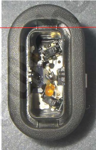
Auf der zum Anschlussstecker gerichteten Seite ist die LED mit einem Vorwiderstand verlötet, diese Lötstelle trennen und die LED nach unten von dem Sockel klappen.
