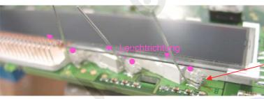
Gebogene LEDs mit der leuchtenden Seite zum Display ausrichten, das gekürzte Beinchen festlöten.
