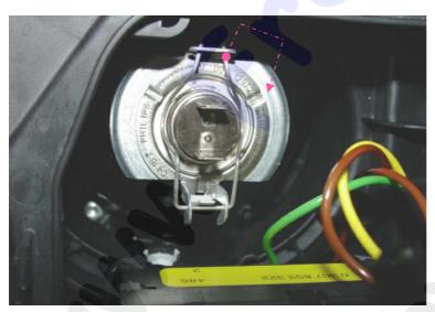
Klammer an der Birne lösen, dafür einen der Arme herein drücken, von der Birne weg bewegen und um die Rastung herum führen. Anschließend mit dem anderen Arm genauso vorgehen.
