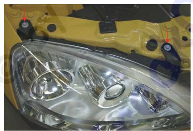
Oben am Scheinwerfer die 2 Sechskantschrauben SW8 entfernen.
