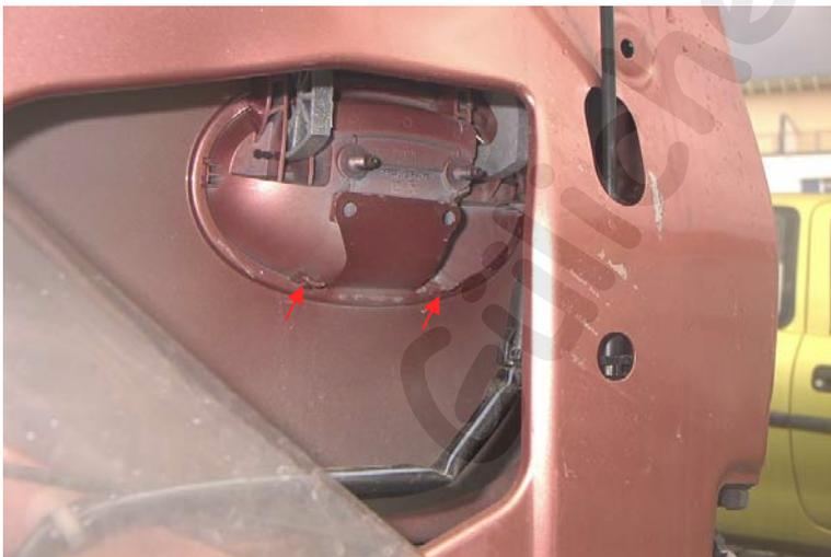
Innen die 2 unteren Rastnasen an der Griffschale nach oben entriegeln und den Griff nach außen drücken.
