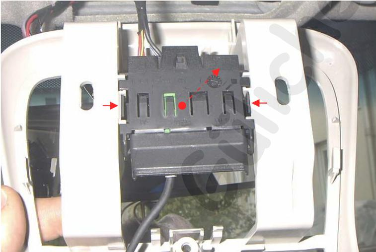
Wenn man den Zentralstecker komplett vom Rahmen entfernen möchte, so muss er links und rechts nach innen entriegelt und nach oben aus der Führung herausgezogen werden.
