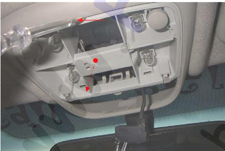
Innenleuchte mit dünnem Schraubendreher an der vorhandenen Nut heraushebeln.
