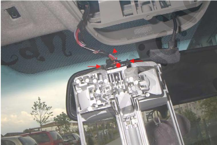
Stecker an der Innenleuchte links und rechts zusammendrücken und abziehen.
