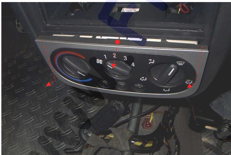
Blendrahmen oben ausclipsen, hierzu mit breitem Schraubendreher leicht hebeln.
