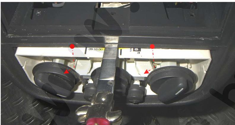
Bedieneinheit oben mittig mit einem Messer oder dünnen Schraubendreher nach unten Drücken und nach vorne herausclippen, dabei darauf achten, dass die Einheit unten nicht wieder einrastet. Bedieneinheit wird oben von 2 Rastnasen gehalten.
