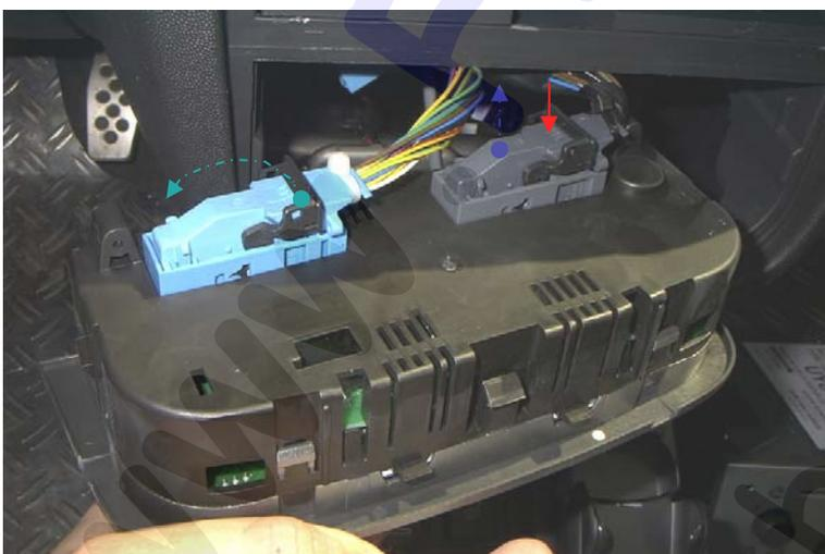
Einheit rundrehen, die beiden Stecker an der schwarzen Klammer **entriegeln** und die Klammer **umklappen**. Stecker anschließend einfach **abziehen**.
