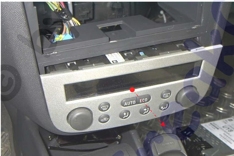
Hinten um die Einheit herum greifen und unten in der Mitte die Rastnase nach oben drücken. Danach die Einheit nach vorne herausziehen.
