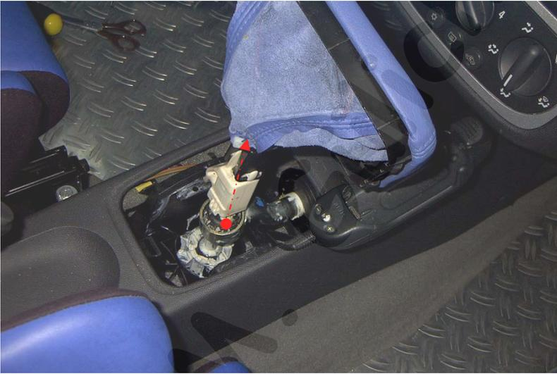
Schaltsack ausclipsen und nach oben über den Schaltknopf legen.
