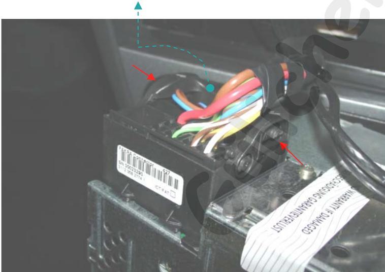
Am Radiostecker seitlich links und rechts den Bügel nach innen entriegeln und diesen nach oben klappen.
