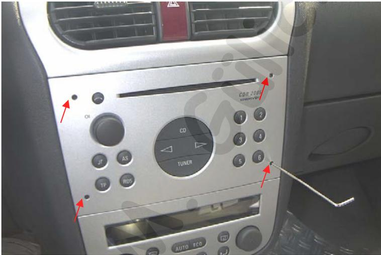
Aus den 4 Löchern für die Radioentriegelung zuerst die Inbusmadenschrauben (2mm-Inbus) herausdrehen.
