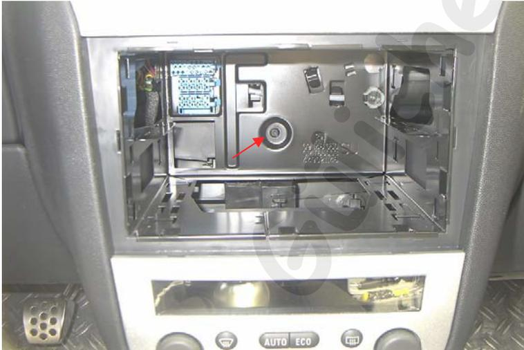
Hinten im Radioköfig die Torxschraube herausdrehen und den Käfig oben und unten zusammendrücken.
