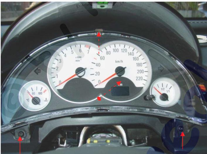
Unten am Tacho die 2 Torxschrauben herausdrehen. Oben am Tacho die Halteklammer nach oben entriegeln und die Tachoeinheit nach hinten entnehmen.
