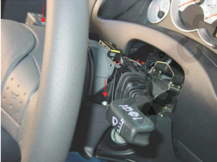
Die 2 Torxschrauben von oben Links und rechts in der Lenkradverkleidung ebenfalls herausdrehen und die Verkleidung nach unten abziehen.
