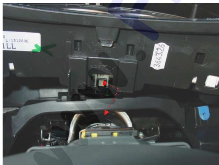
Je nach Baujahr vom Fahrzeug kann es sein, dass der Anschlussstecker vom Tacho nicht in der Armaturentafel, sondern direkt am Tacho verclipst ist. Ist das der Fall, einfach die Klammer nach unten entriegeln und den Stecker nach hinten abziehen.
