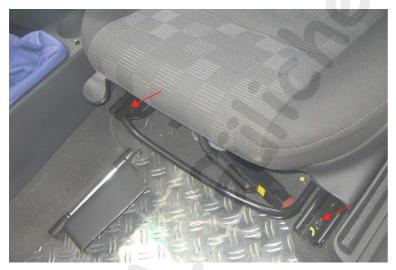
Die vorderen beiden Befestigungsschrauben (T40) aus der Laufschiene herausdrehen.
