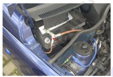
Wegen Arbeiten an Seitenairbag und Gurtstraffer muss der Massepol der Batterie zuerst abgeklemmt werden. Nach dem Abklemmen 30 Sekunden warten, bevor man den Stecker auseinander nimmt.
