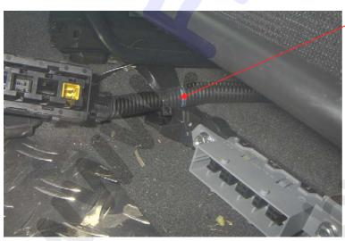
Halteclip am Kabel unten mit einem Schraubendreher oder einer abgewinkelten Spitzzange zusammendrücken und nach oben herausziehen.
