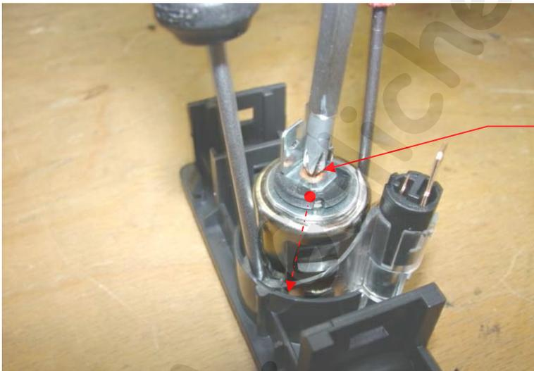
Nun einen Kreuzschlitzschraubendreher oder vergleichbares hinten auf die Metallhülse aufsetzen und mit einem Hammer den Schraubendreher samt Hülse vorsichtig aus dem Beleuchtungsring heraus treiben.
