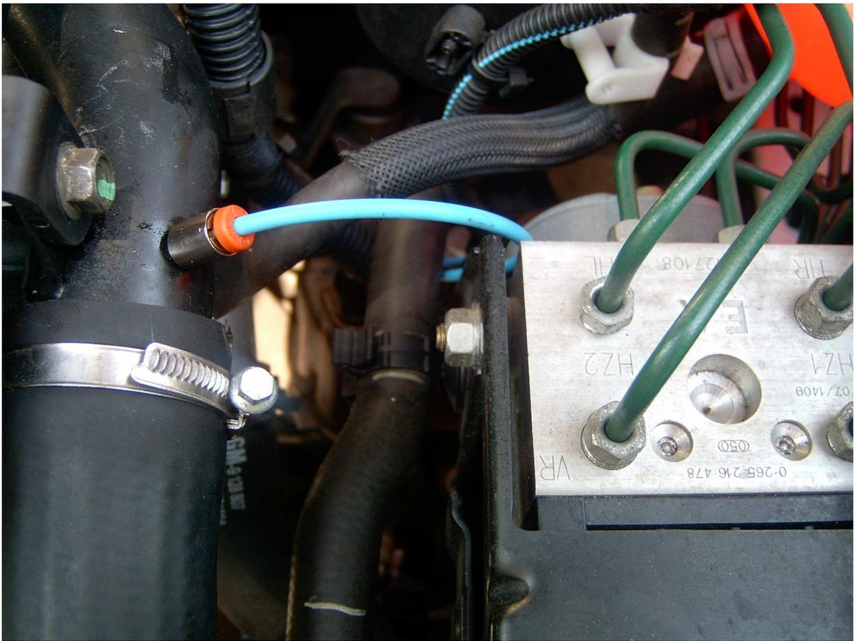
Hier seht ihr rechts den ABS-Block und links die schlauchselle. Das Blaue ist der neu angebrachte Schlauch, der über so einen Verbinder in das Druckrohr geht.
