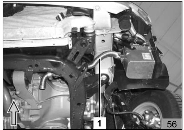
**Abgasanlage verlegen für Fahrzeuge mit Automatikgetriebe**
