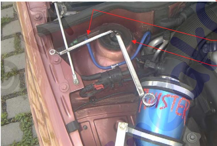
Befestigungsmutter vom Federbein beidseitig aufdrehen, dabei an dem Gewinde mit einem kleinen Schlüssel kontern, und zusammen mit dem Teller entfernen.
