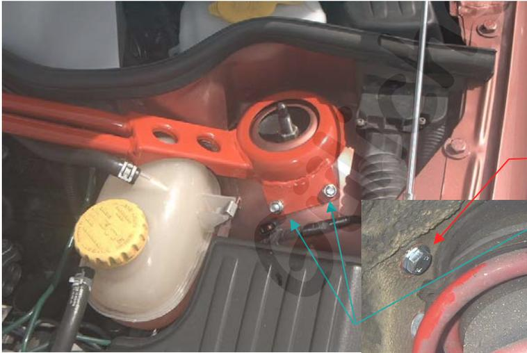
Klebeband nach dem Trocknen abziehen, die Domstrebe wieder aufsetzen, die Schrauben jeweils mit der U-Scheibe versehen und vom Radhaus her durch die Löcher und die Domstrebe stecken und mit den Muttern zuerst fixieren.
