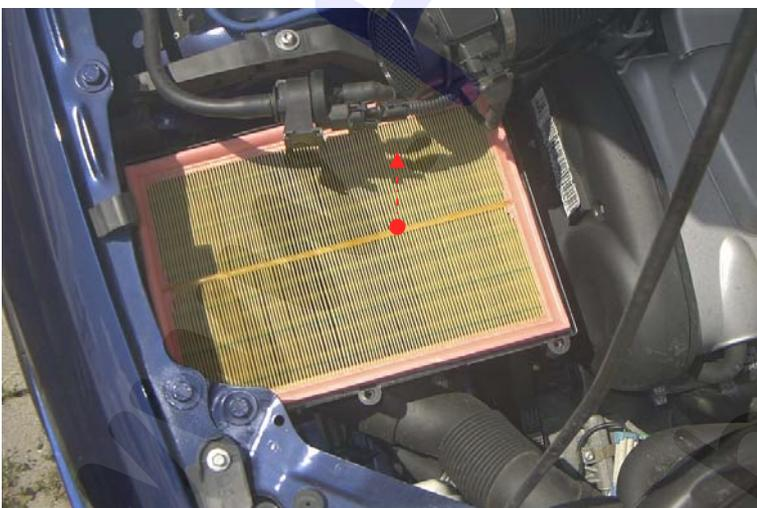
Filterereinheit aus dem Kasten entnehmen, etwaigen Dreck im Kasten aussaugen, neue Filterereinheit einsetzen und den Kasten wieder zusammen setzen.
