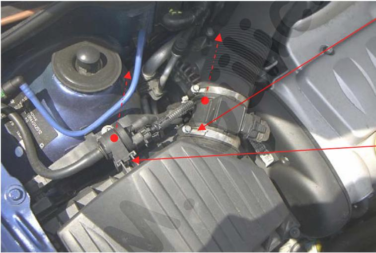
Schelle vor dem Luftmengenmesser aufdrehen und den Luftmengenmesser vom Luftfilterkasten abziehen.
