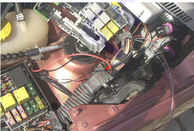
Das Kabel unter der Sicherungseinheit entlang zur hinteren Gummidurchführung verlegen und durch diese hindurch ziehen.
