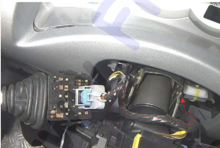
Kabel in den Blinkerhebelstecker auf der freien Position einpinnen und am Kabelstrang entlang nach hinten zum Armaturenhauptkabelsatz verlegen. Kabel dabei mehrfach mit Kabelbindern fixieren, um ein Scheuern oder verhärten des Kabels zu vermeiden.
