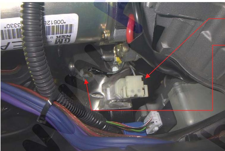
Den Anschlussstecker auf den Schalter aufstecken und das Kabel mit dem Kabelclip in der vorgesehenen Aufnahme fixieren.
