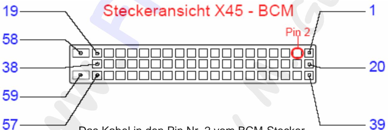
Das Kabel in den Pin Nr. 2 vom BCM-Stecker einpinnen und die Verriegelung wieder einsetzen.
