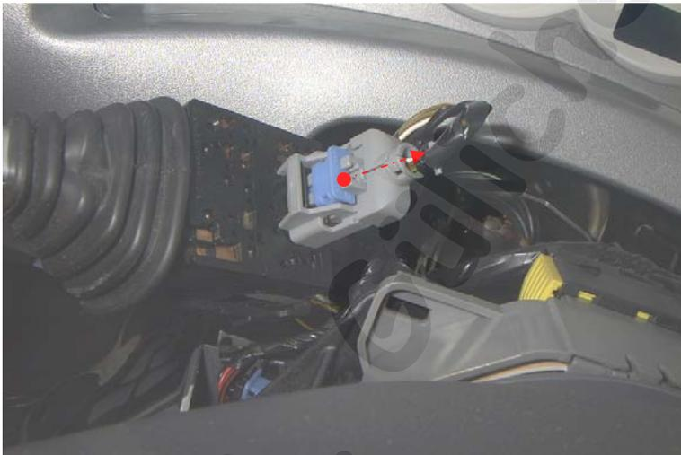
Verriegelung am Stecker vom Blinkerhebel nach hinten lösen und den Stecker abziehen.
