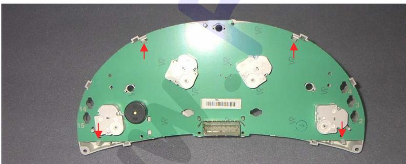
Tacho herumdrehen und die Platine von dem PVC-Rahmen lösen. Hierzu einfach die 4 Rastnasen lösen und die 2 Teile auseinander ziehen.
