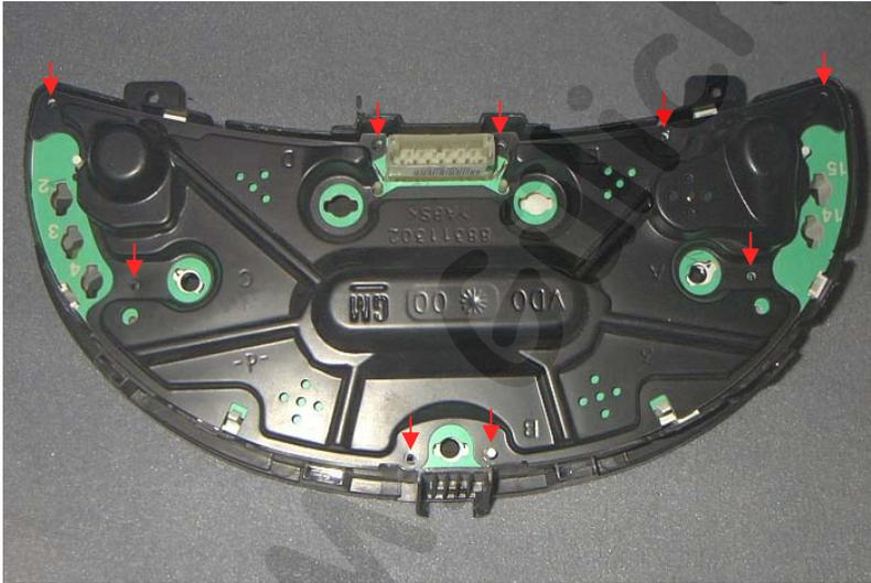
Hinten aus der Einheit die Torxschrauben herausdrehen und die Plastikabdeckung entfernen.
