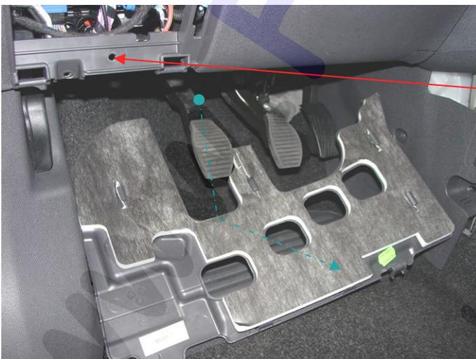
Bei Ausstattung mit Fußraumverkleidung zuerst links die Torxschraube T20 entfernen und danach rechts die Rastnase entriegeln. Danach die Verkleidung nach unten entnehmen.
