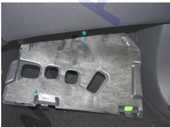
Anschließend die Verkleidung nach unten entnehmen.
