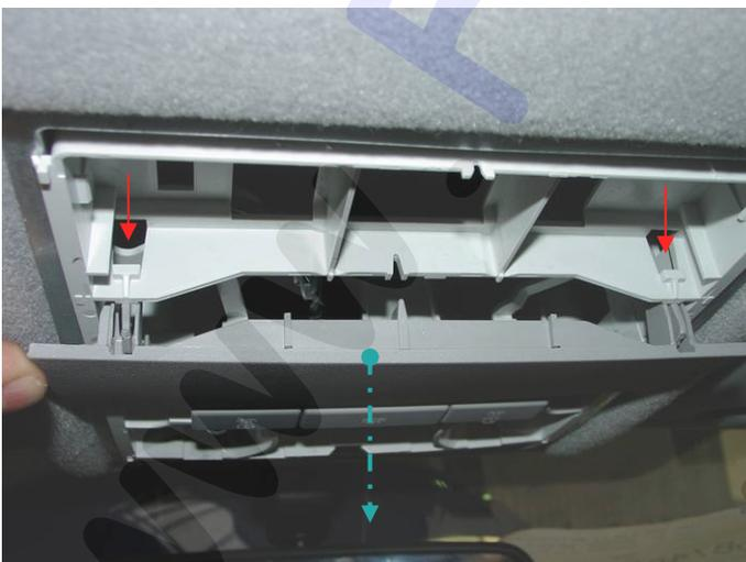
Die mittlere Blende mit einem dünnen Schraubendreher hinten rechts und links entriegeln und nach unten entnehmen. Bei Ausstattung Alarmanlage die Blende nur herunter hängen lassen.
