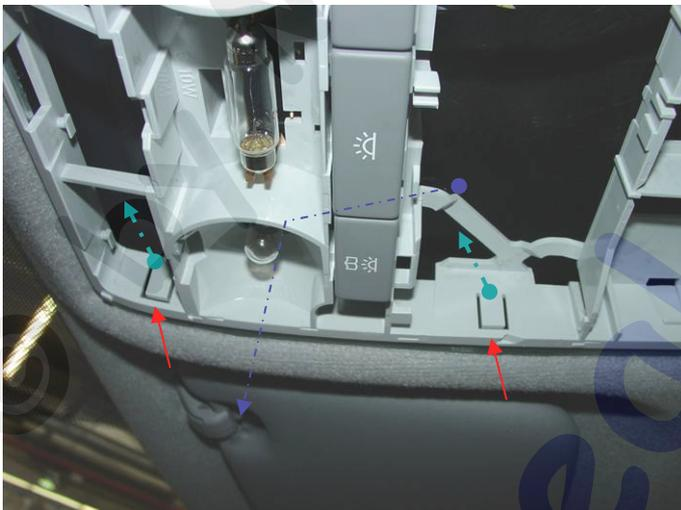
Links und rechts am Lampenträger jeweils die 2 Rastnasen zur Innenseite hin entriegeln, zuerst vorne links und rechts, danach hinten links und rechts. Anschließend die Innenleuchteneinheit nach vorne, unten aus dem FZ-Himmel entnehmen.
