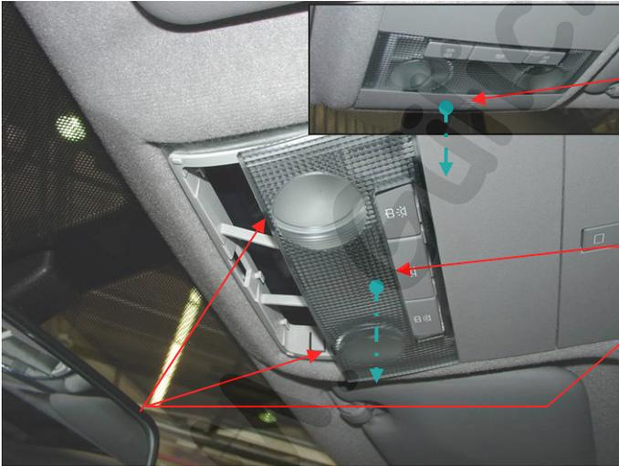
An der Innenleuchte die vordere Blende nach unten ausclipsen. Wenn vorhanden das Mikrophon hinten in der Blende entriegeln und aus dieser entnehmen. Anschließend die Streuscheibe durch vorsichtiges Hebeln mit einem Schraubendreher vorne ausclipsen und durch wackeln danach hinten ausclipsen.
