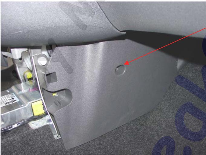
Rechts in der Heizungsverkleidung die Torxschraube T20 entfernen. Bei Ausstattung mit Fußraumverkleidung diese hinten an der Heizungsverkleidung ausclipsen.
