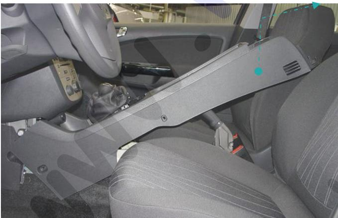
Mittelkonsole hinten nach oben über den Handbremshebel heben und nach hinten heraus ziehen.
