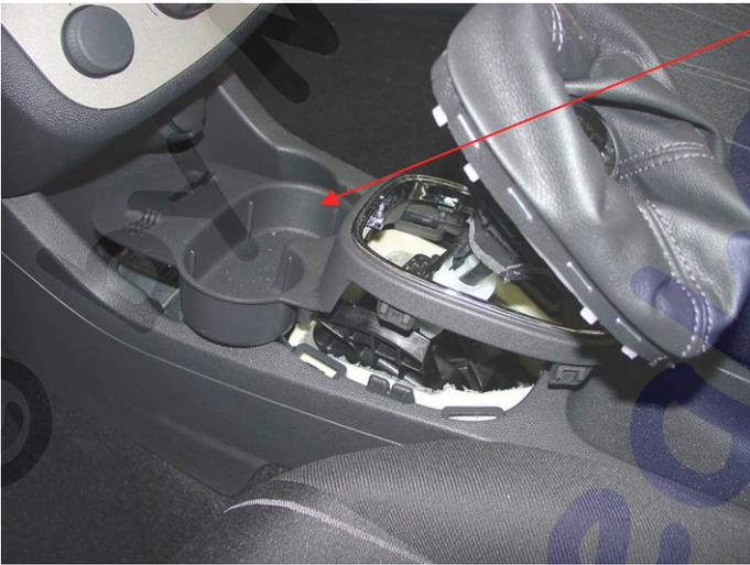
Dosenhalterereinheit ausclipsen und nach oben über den Schalthebel entnehmen.
