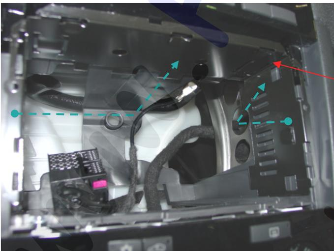
Den Radiokäfig seitlich links und rechts leicht zusammen drücken und nach vorne aus der Armaturentafel heraus ziehen.
